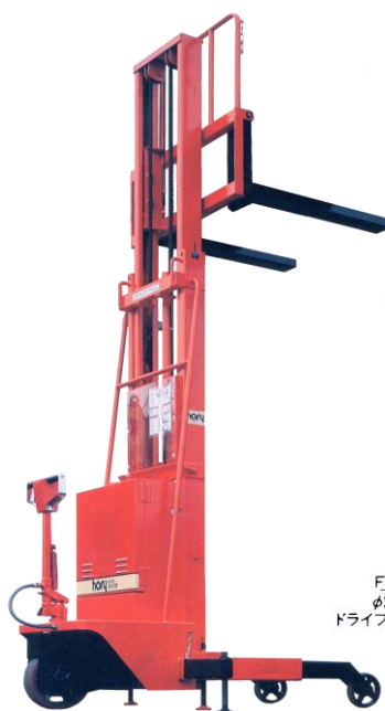
梁型枠揚げ用
