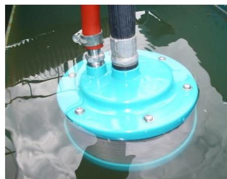
洗浄ガンのレバーを離すと、ストレナー内側の回転ノズルから余水が強力に噴射され、給水フィルターに付着したゴミ・汚れを飛ばす構造になっていますので、現場での給水トラブルが激減します。
