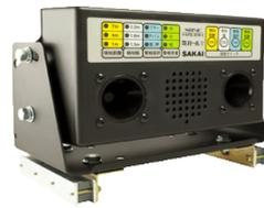
取付はマグネット式で、超音波センサーによる検知距離は7m・4m・1mの3段階で設定できます。電源はDC12V・24V。
