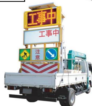
車載して 標識車として使用できます。
